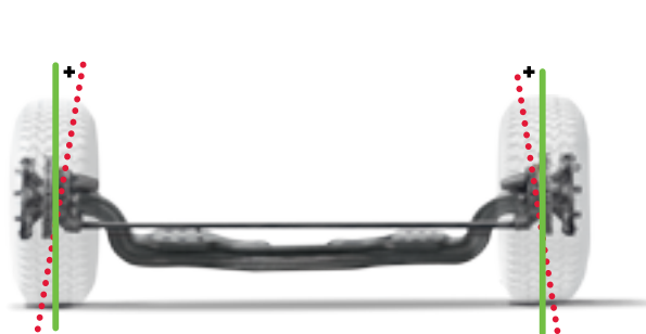
Поперечный угол наклона шкворня
